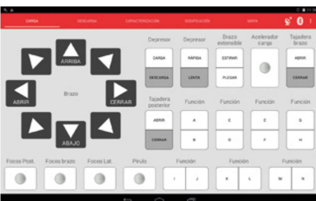
Cajas de mandos, botoneras mecánicas o digitales a través de una tablet mediante Bluetooth.
