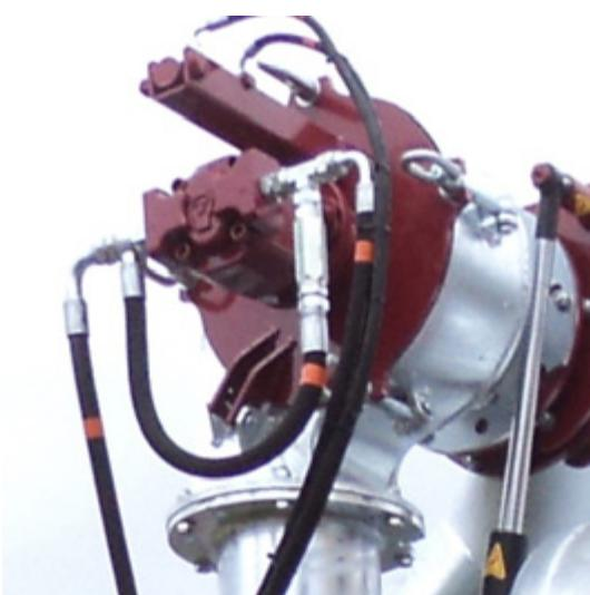
■ Acelerador de carga totalmente galvanizado, con todo el interior fabricado en inox, de fácil acceso y apertura.
