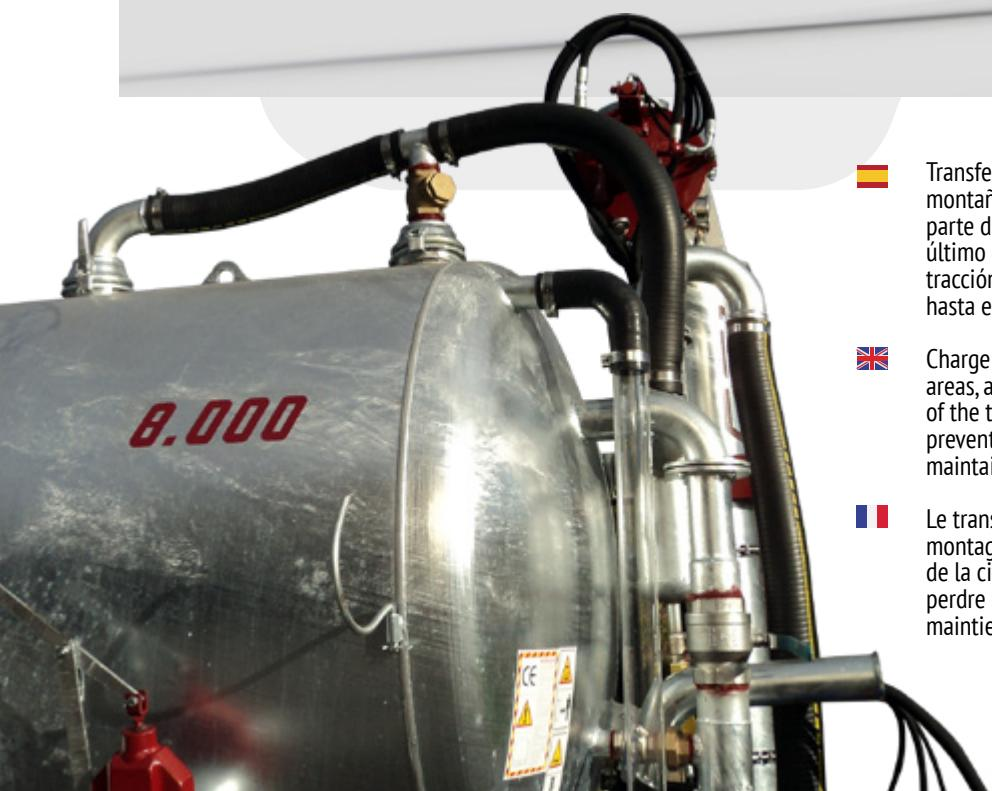
■ Transferencia de carga, es un sistema diseñado para zonas montañosas, ya que gracias al montaje de un depósito en la parte delantera de la cisterna conseguimos que éste sea lo último que se descargue para que así no perdamos la tracción del tractor, gracias a tener peso en el enganche hasta el último litro.
