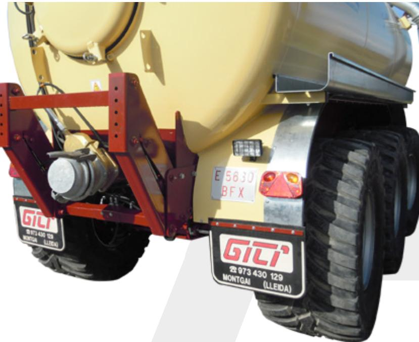
■ Elevador tripuntal para todo tipo de aplicadores de la amplia gama que montamos. Totalmente amarrado al chasis. Montado con suspensión y paralelogramo.
