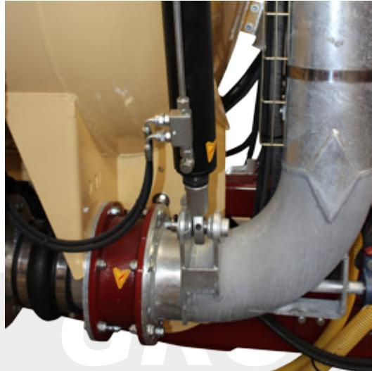
■ Soporte inferior del brazo de carga montando todos los cilindros con rótulas y válvulas pilotadas antirretorno, los bulones casquillados con engrasadores, flector de goma para evitar roturas, rodamiento plano y tajaderas industriales de pala inox.
