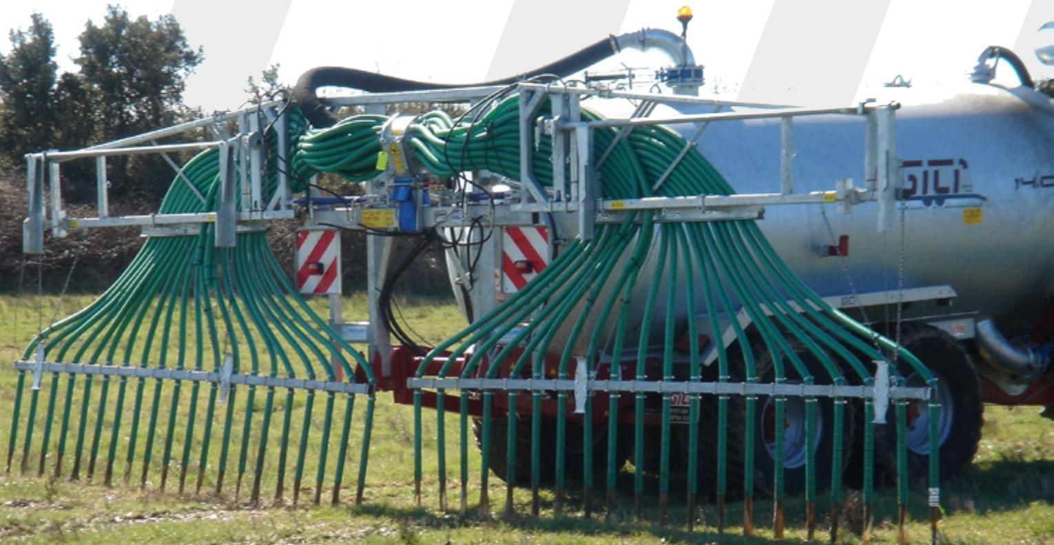
■ Aplicador de tubos marca GILI de 6 y 9 metros con triturador. El de 9 metros con 30 salidas de diámetro 40 o 50mm. Con un diseño ergonómico de peso ligero y fácil acceso a todos sus puntos. Enganches rápidos para una rápida función de enganche y desenganche.
