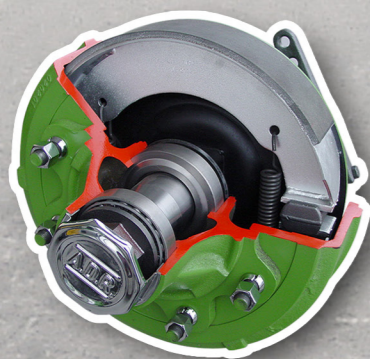
Eje agrícola con freno normal Agricultural axle with normal brake Essieu agricole avec frein standard
