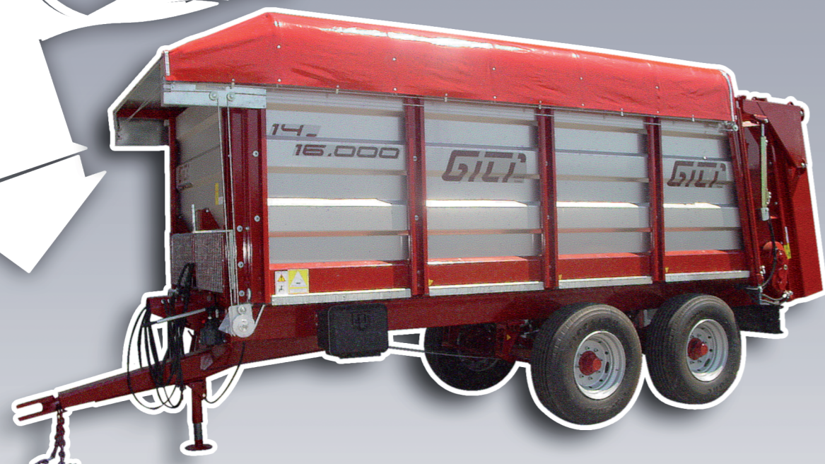
ESPARCIDOR CON TOLDO Y TAPA POSTERIOR CON MOLINETES SPREADER WITH A SHEET AND BACK COVER WITH BEATERS ÉPANDÉUR D'UNE FEUILLE ET LA FAÇADE ARRIÈRE AVEC GUINDEAUX
