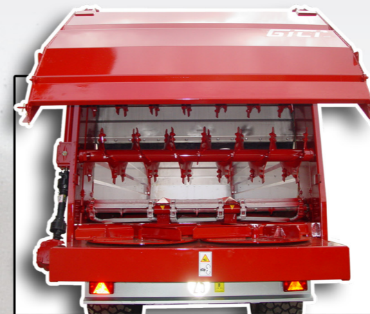
Molinetes horizontales con platos especiales para compost. Horizontal beaters with special dishes for compost. Guindeaux horizontal avec des plats spéciaux pour le compost.
