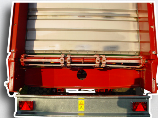
4 ó 6 cadenas de arrastre con tensores independientes 4 or 6 independents chains drag tensors 4 ou 6 chaînes indépendantes glisser tensors
