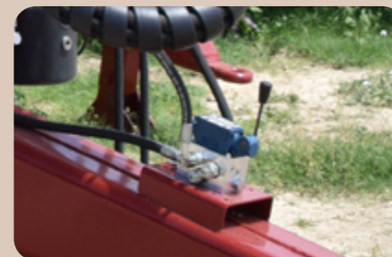
Selector de intensidad del frenado (suave, normal, fuerte) Brake intensity selector (soft, normal, strong) Sélecteur d'intensité de freinage (doux, normal, fort)
