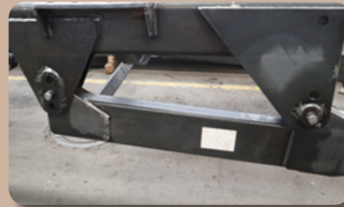
Flecha de altura regulable · Height adjustable A-frame · Flèche réglable en hauteur
