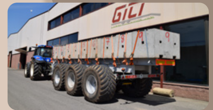
Uno de los vehículos de prueba para la homologación europea con carga máxima One of the test vehicles for the European type approval with maximum load Un des véhicules test pour l'homologation européenne avec une charge maximale.
